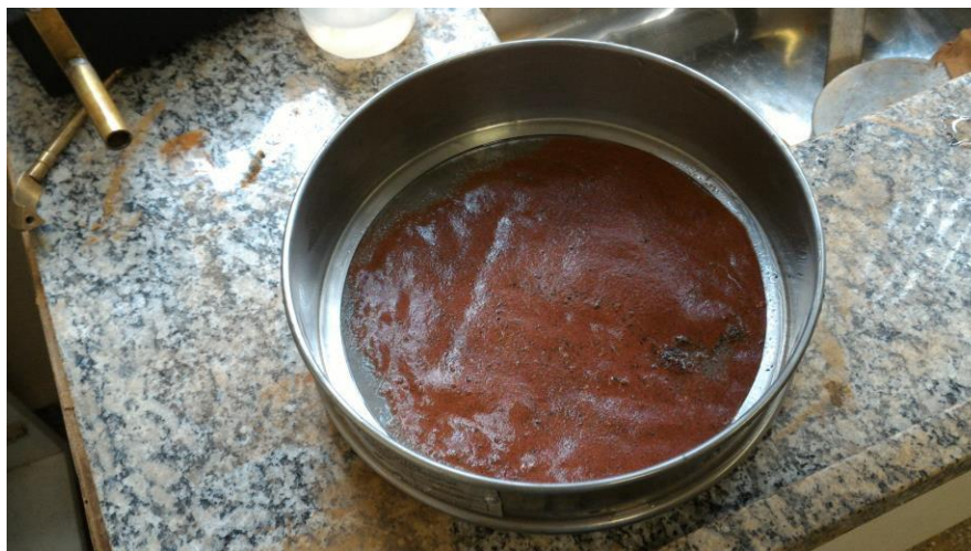
Figura 2 – Lavagem de 120 gramas de solo na peneira 0,075mm.
