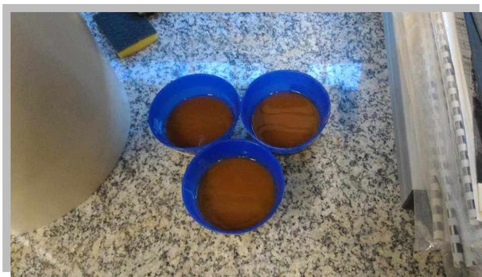
Figura 5 – Imersão do solo em água destilada.
