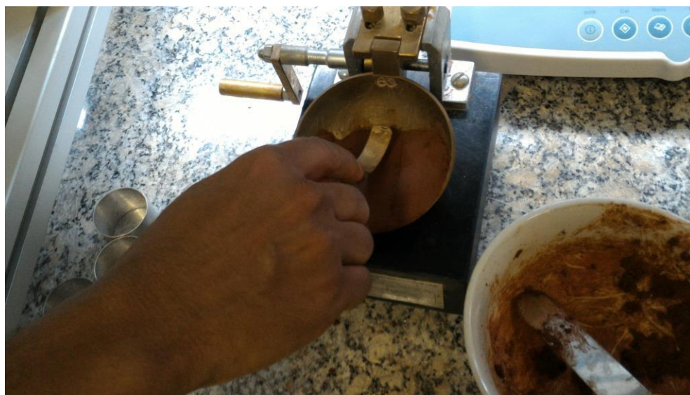
Figura 3 – Aparelho de Casagrande com o material para ensaio. Fonte: O autor.
