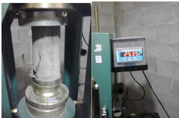
Figura 18 - Corpos de prova rompidos à compressão
