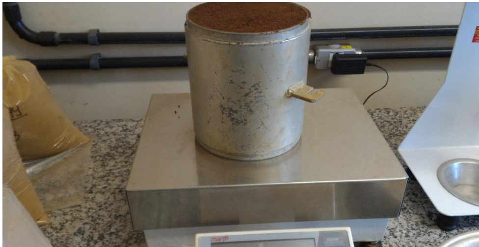
Figura 6 – Pesagem do conjunto solo e cilindro após compactação da amostra. Fonte: O autor.
