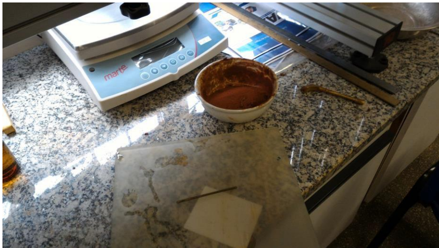
Figura 4 – Ensaio de plasticidade com seus respectivos materiais.
