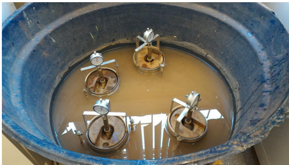
Figura 7 – Colocação do extensômetro na haste de expansão.
